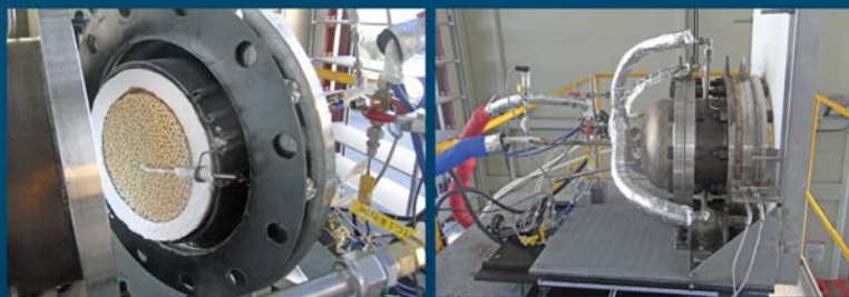
反応デバイスをソーラー反応器に設置
