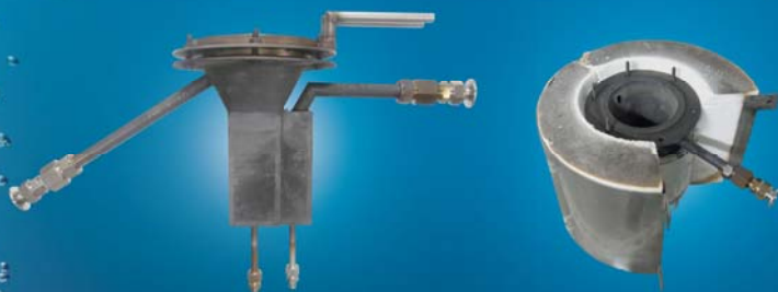
横から見た内循環流動層によるソーラー反応器
