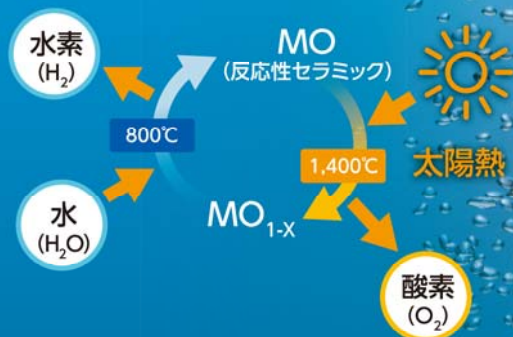
2段階水熱分解サイクルの概念図
